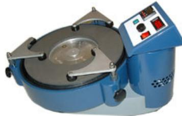
MACOLAEPP-Spezialscheiben eignen sich besonders für die Bearbeitung von Kleinteilen, an die hohe Ansprüche im Hinblick auf Oberflächengüte gestellt werden. MACOLAEPP-Scheiben werden trocken eingesetzt. Offensichtliche Vorteile sind:
